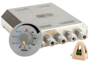
Commande facile d'utilisation pour **sauna sec et humide** jusqu'à 11,0 kW (extensible avec sectionneur de puissance LE1). Commande de petite dimension, montage à l'intérieur ou à l'extérieur du sauna. Réglage en continu de 65 à 35 % et de 35 à 65 °C en mode humide ou de 65 à 105 °C en mode sauna. limitation de la durée de chauffage de 6 h, coupure de sécurité de la température à 128 °C. boîtier externe, banc capteur avec câble (3,5 m), lumière marche/arrêt, fonction de réglage de l'aération.
