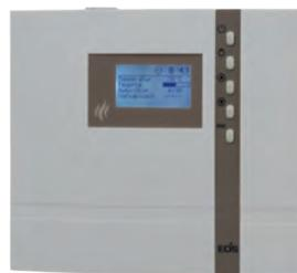
Commande électrique pour **sauna sec et humide**. Réglage en continu de 30 à 70 °C en mode humide ou de 40 à 115 °C en sauna sec. Évaporateur 3 kW. Production d'humidité à 5 paliers avec détection de manque d'eau et fonction de prolongation de chauffe. Affichage numérique de l'heure, de la température, de l'humidité et de la durée de fonctionnement restante.
