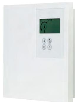
Commande électrique pour **sauna finlandais** avec affichage LCD. Réglage en continu de 70 à 115 °C, limitation de durée de chauffage de 6 h, puissance de coupure 9 kW. Affichage de la température et de la durée de fonctionnement restante. Capteur de température avec câble (3 m) inclus, limitation de température de sécurité à 141 °C, lumière marche/arrêt.
