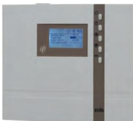
Commande électrique pour **sauna finlandais** avec grand affichage LCD. Réglage en continu de 30 à 115 °C, limitation de la durée de chauffage de 6 h (12 h), puissance de coupure 9 kW (extensible avec sectionneur de puissance LSG), heure, temps présélectionné, température et durée de fonctionnement restante, verrouillage des touches / sécurité enfants, capteur de température avec câble (2 m) inclus, limitation de température de sécurité à 139 °C, lumière marche/arrêt.
